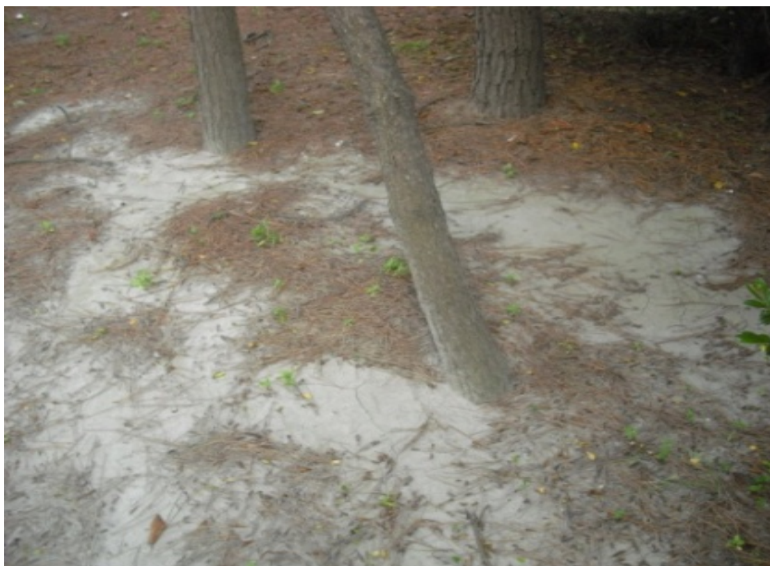
松林の中の噴砂(護岸表～海岸方向(船橋三番瀬海岸))
