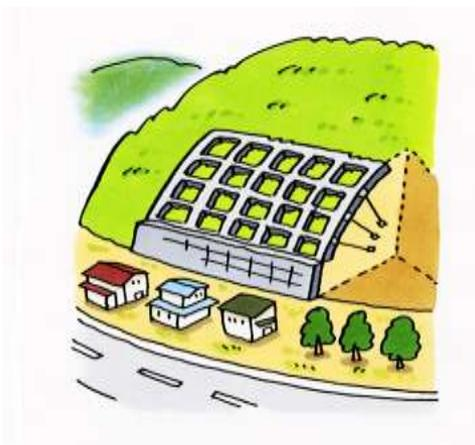
図-5.1 かけ崩れ防止対策（砕工+アンカー）
